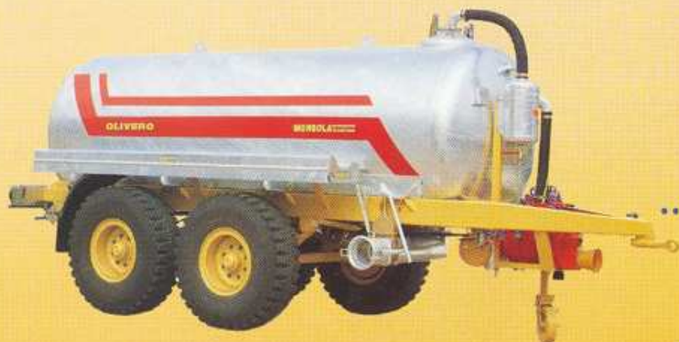
CARROBOTTE con asse posteriore sterzante
